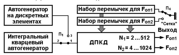
В случае невозможности приобретения интегрального высокостабильного кварцевого генератора, его можно заменить на автогенератор, собранный на дискретных элементах и ИС, который также имеется в предлагаемой схеме. Однако стабильность формируемых частот будет хуже. Выбор используемого кварцевого генератора производится с помощью перемычки П1.
