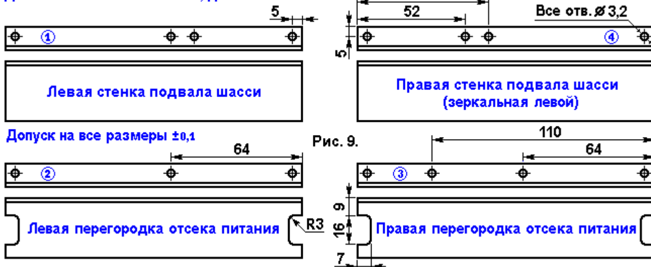
Детали 1-4: Уголок 30×12×2, длина 145 мм.
