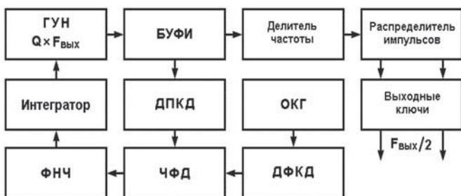
Рис. 1. Синтезатор на ФАПЧ с ДПКД
