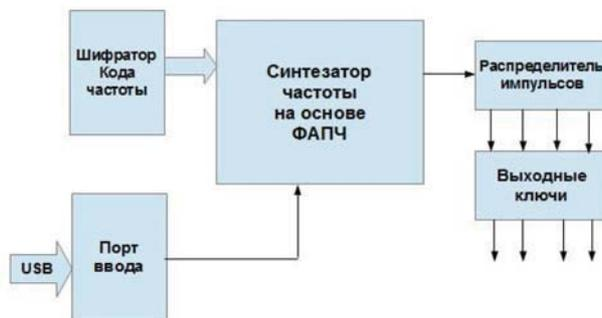
Рис. 2. Синтезатор на петле ФАПЧ на основе специализированной ИС
