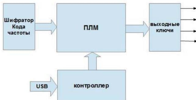
Рис. 3. Синтезатор на ПЛМ
